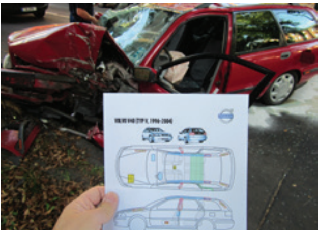
AUSKUNFTSERSUCHEN Eingabemaske im System SilverDAT zur Identifizierung des Fahrzeugtyps über sein amtliches Kennzeichen (oben) Rettungsdatenblatt in der praktischen Anwendung (unten)
